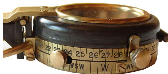
Seitliche Skala mit Arretiermechanismus der Perlmutscheibe
