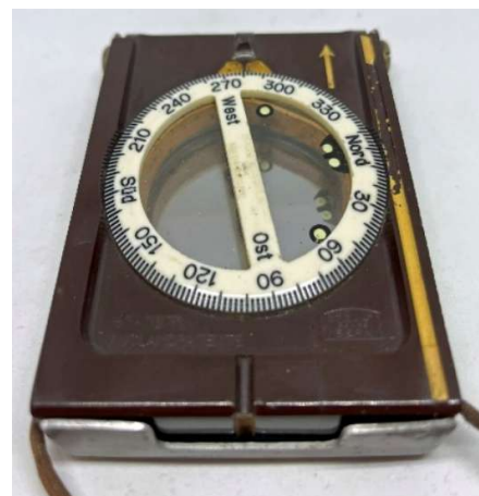
Kompassgehäuse aus Bakelit und einem Metalldeckel
