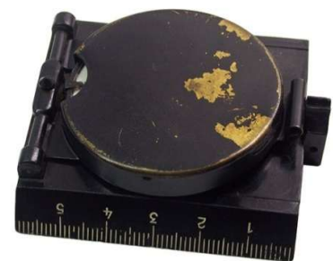
Metallspiegel mit Anlegekante
