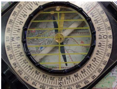
Kührt II mit Steinlagerung der Nadel
