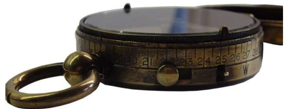
Seitenansicht mit Feststellhebel, Arretierstift und Randskala
