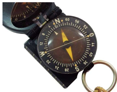
Skala 64-00 Strich linksdrehend Deklinationskorrektur bei 180 Strich WEST
