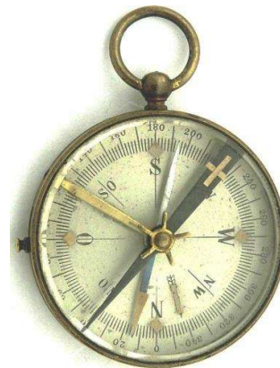
Marschkompass mit einer Direktionslinie
