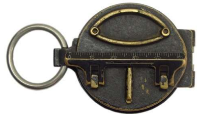
Gehäuseboden Armeemodell mit umklappbarer Anlegekante
