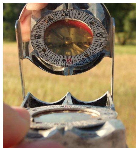
Ablesung an der Nadel über den Spiegel
