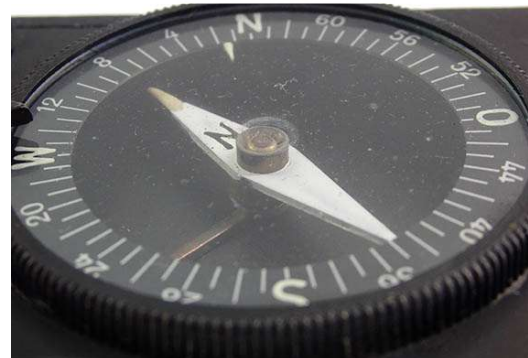
Skala mit Deklinationskorrektur
