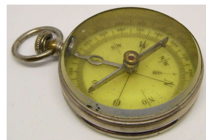
Kartenkompass mit einer Remontoirarretierung
