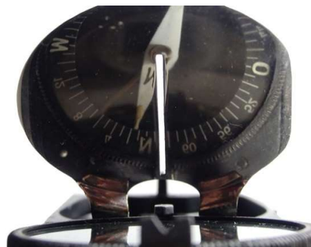
Anvisieren über den Peilschlitz
