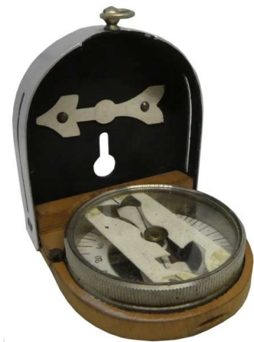
Diopterbussole aus dem Jahre 1905 nachleuchtend durch Balmainflüssigkeit
