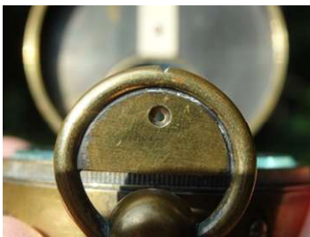
In die Öse ist die Kimme als Lochdiopter eingefügt
