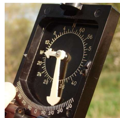
Kippen des Deckels und Ablesen des Steigung
