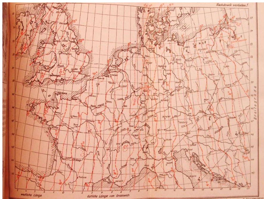
Karte der Magnetischen Deklinationen für Mitteleuropa Stand 01.07.1934
