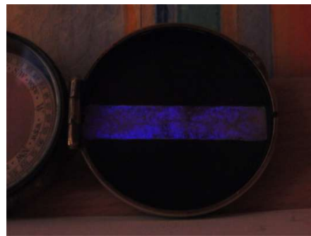
Orientierungsstrich nachleuchtend für das Anpeilen der Marschrichtung
