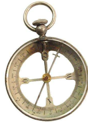
K. S. Stockert ca. 1915 Remontoirarretierung und Balkennadel
