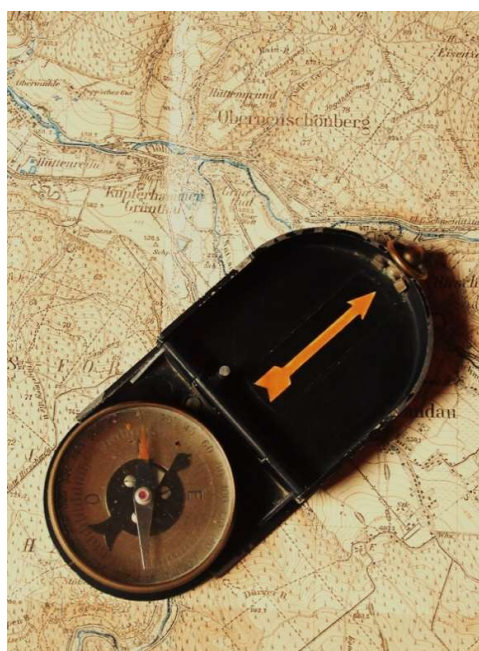
Ermitteln der Marschrichtung mittels dem Modéle 1922 auf einer Meßtischkarte 1:25.000
