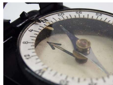
Kupferring unterhalb der Kompassnadel für „Kompass ruhig einspielend“
